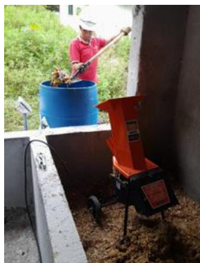
Se trituran y se mezclan con material seco y se aplican microorganismos eficientes.
